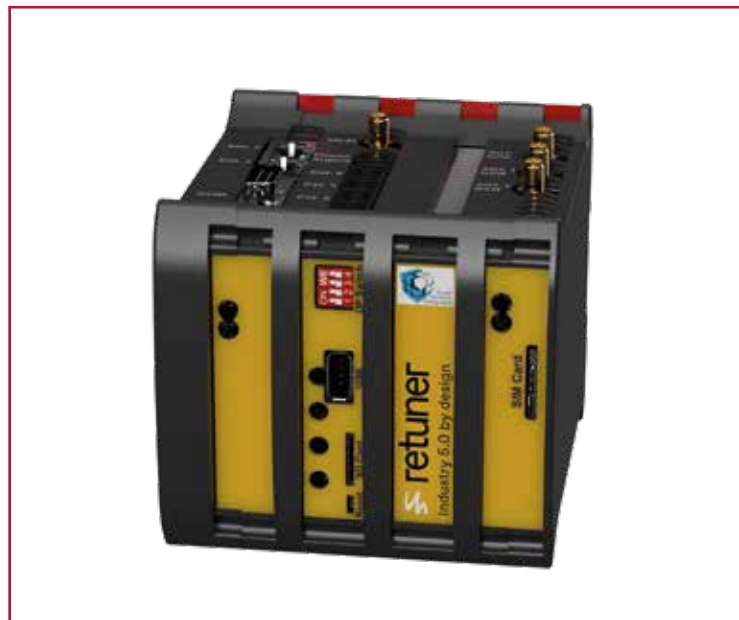
Smartedge5.0 permette il dialogo con la macchina scambiando informazioni in entrambe le direzioni su qualsiasi protocollo
